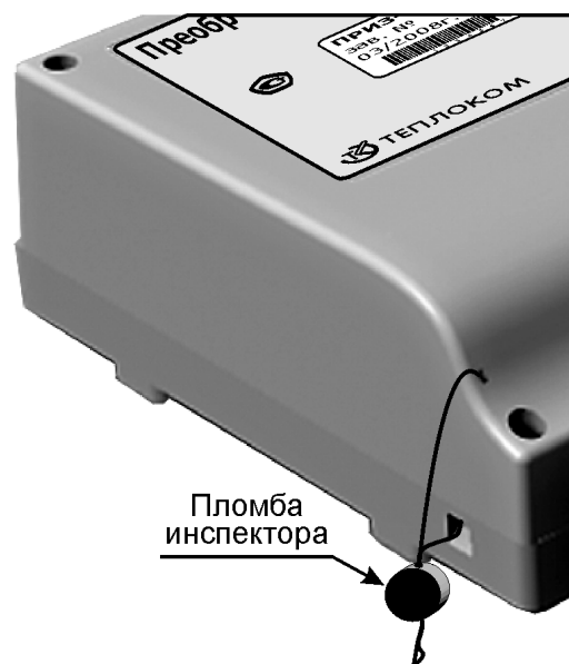
Рисунок 5 – Место пломбирования корпуса преобразователя (по диагонали имеется второе место для пломбирования)
