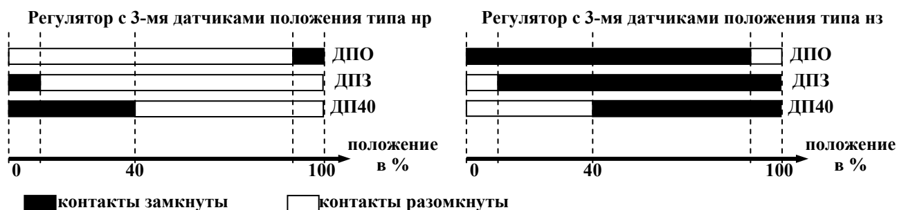
Рисунок 6.7.3.3.1 Состояние контактов регуляторов с 3-мя ДП в зависимости от их типа
