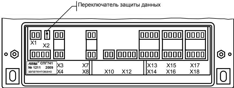
Рисунок 3.2 б – Монтажный отсек корректора СПГ741.02
