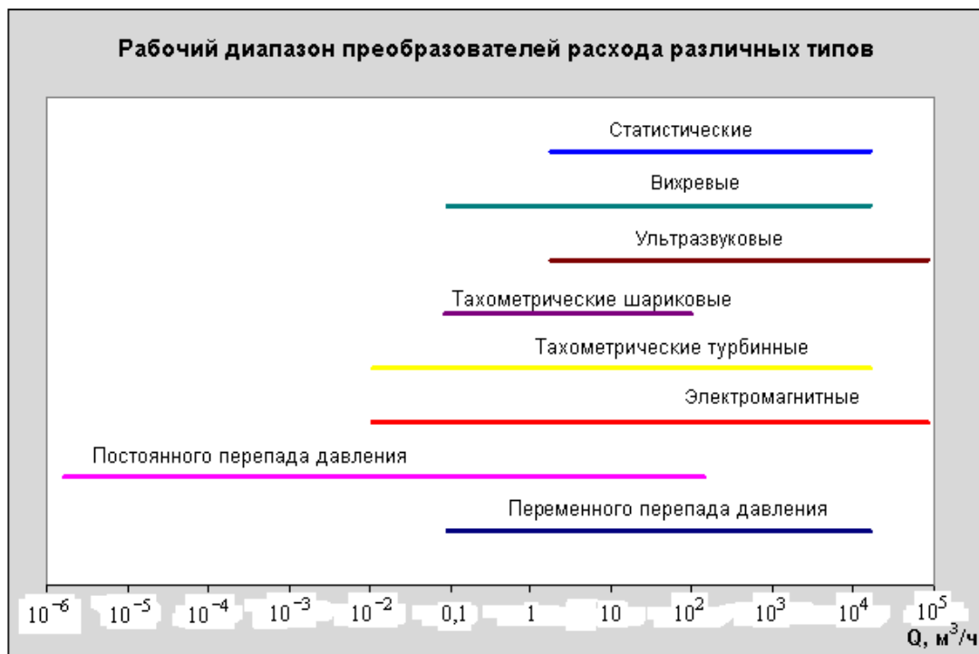
Рис.1. Рабочий диапазон преобразователей различных типов.
